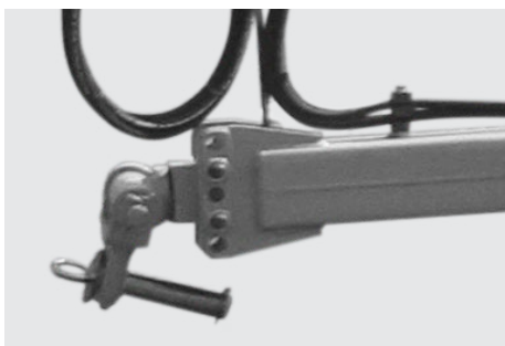
Jumelo regulável com rótula para redução de esforço do mesmo. Adjustable hitch bar with rod to reduce the effort in the bar. Enganche regulable con unión (rodilla) para reducción del esfuerzo en el enganche.
