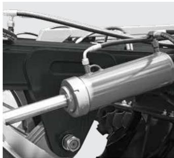
Cilindros hidráulicos de articulação, para transporte e para levantamento dos pneus.
